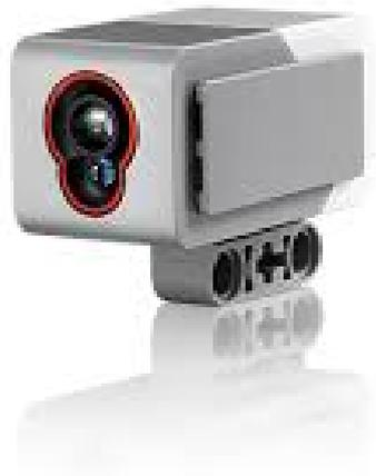
**Датчик цвета** — это цифровой датчик, который может определять цвет или яркость света, поступающего в небольшое окошко на лицевой стороне датчика.
